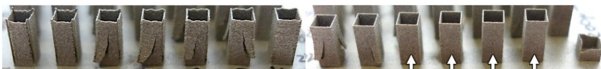
**Abbildung 21:** Konturquader mit variierender Laserleistung und Scangeschwindigkeit aus FeCrMoVC zur Bestimmung der Supportparameter und Konturparameter. Potenziell geeignete Parameterkombinationen sind mit Pfeilen gekennzeichnet.
