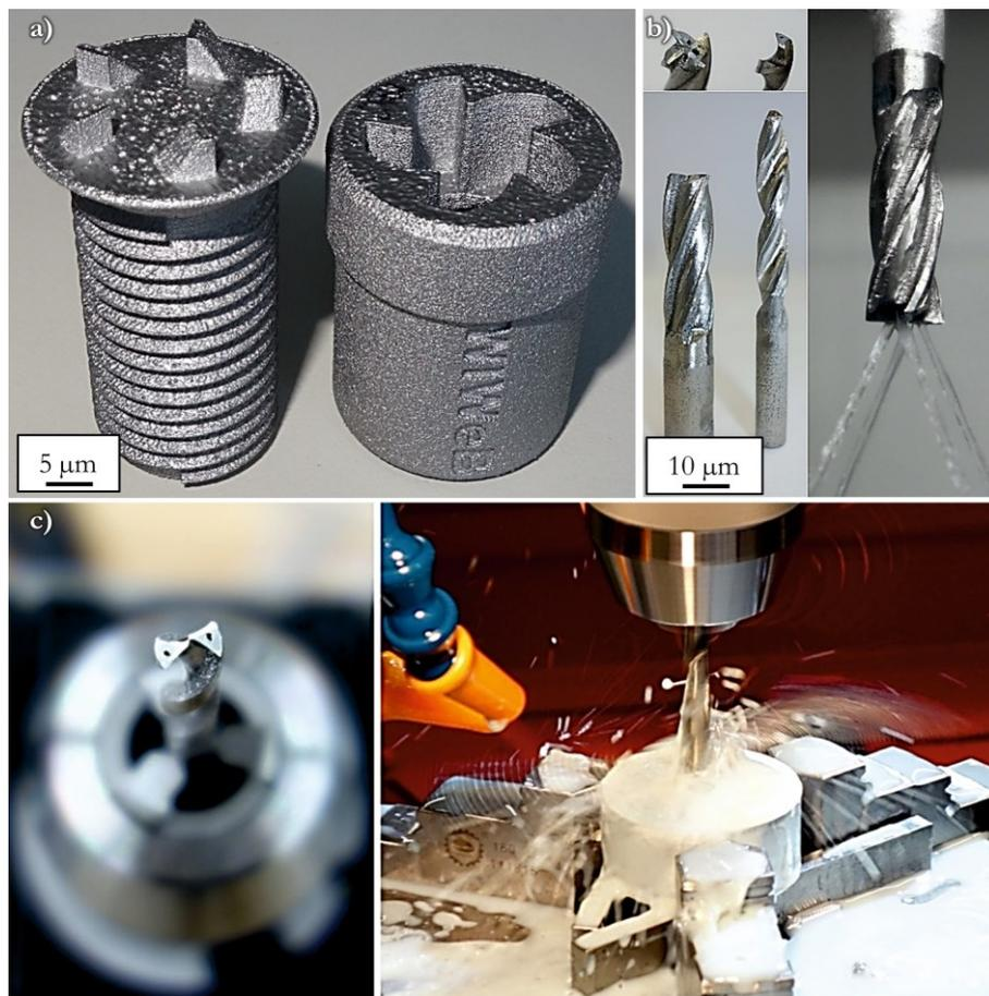
**Abbildung 79:** Ausgewählte SLM gefertigte Werkzeuge. a) Sondersteckschlüssel und Schraube mit Einwegantrieb aus FeCrVWC; b) Bohrer und Fräser aus FeCrMoVC mit innenliegenden Kühlkanälen (nach [266]); c) Testlauf eines Bohrers aus FeCrMoVWC (nach [266]).
