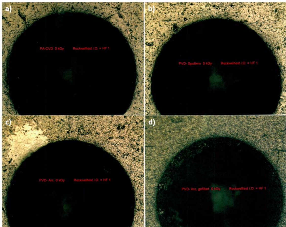
Abbildung 15: Haftfestigkeitsbestimmung der verschiedenen DLC-Beschichtungen
