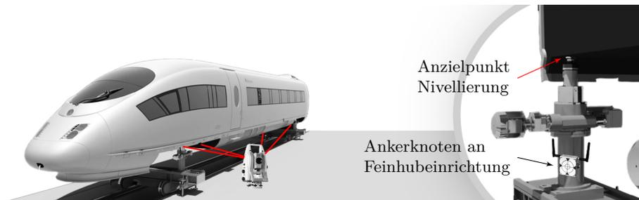
**Abb. 5.17:** Nivellierung des Schienenfahrzeugs (nach Ullrich 2015)
