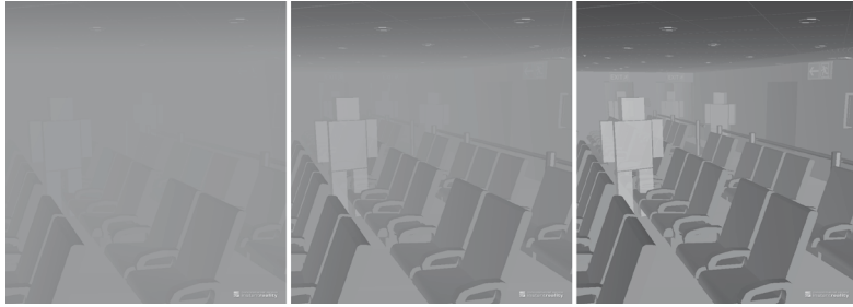
Abbildung 6: VR-gestützte Auswertung einer Evakuierungssimulation mit unterschiedlicher Sichtweite durch Rauchausbreitung
