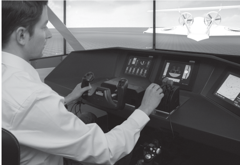
Abbildung 8: Trainingssimulator für Bodeneffektfahrzeuge am Fraunhofer IGD in Rostock
