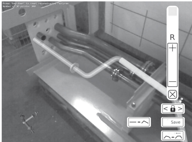
Abbildung 7: Konstruktion von Rohren im realen Kontext mittels Mixed Reality
