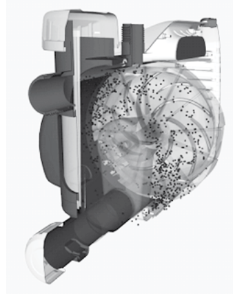
Abbildung 6: Darstellung der Strömung in der Kärcher-Gartenpumpe GP 60 mittels Partikeln in COVISE
