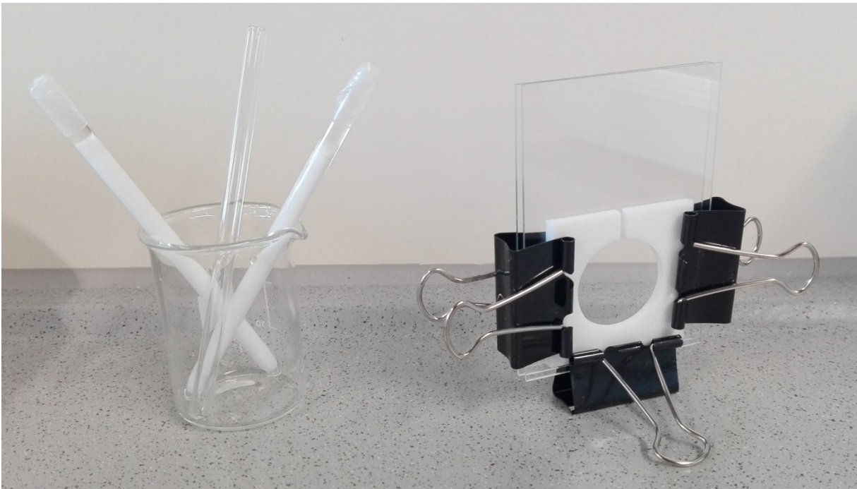
Abbildung 60: Verwendete Polymerisationsgefäße: Glasröhrchen (links), Zylinderform (rechts)
