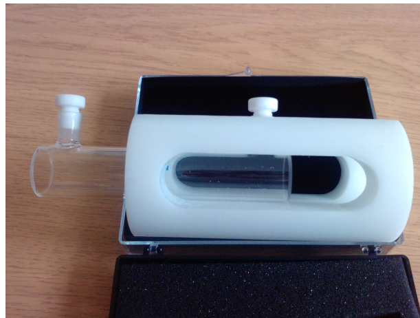
Abbildung 4.0.1: Küvette mit Stabilisierungszylinder aus Polyoxymethylen (POM).
