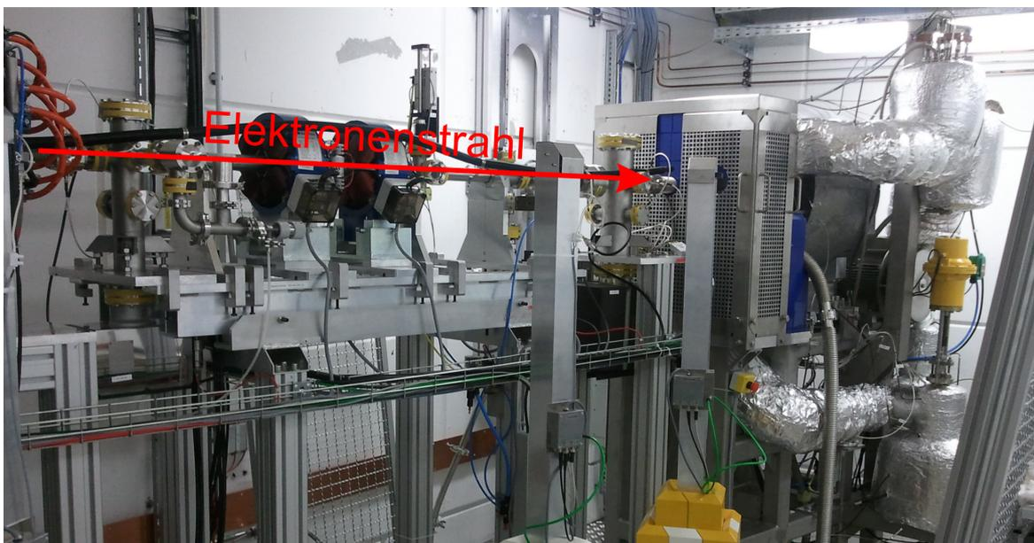
**Abbildung 3.0.2:** Foto der neuen Photoneutronenquelle. Der auf die Quelle auftreffende Elektronenstrahl ist mit einem roten Pfeil dargestellt. Zur Abschirmung der erzeugten Dosisleistung ist die Strahlglöcke, in welcher sich das mit flüssigem Blei gefüllte Molybdänröhrchen befindet, mit blauen Bleisteinen ummantelt.
