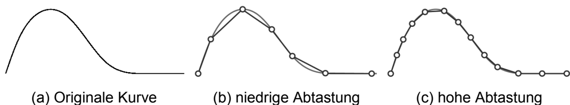
Abb. 14 - Diskretisierung einer Kurve durch diskrete Punkte [45]
