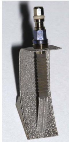
Abb. 51 - Dentalimplantat im Modellversuch, befestigt mittels Laserschweißverbindung
