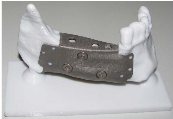
Abb. 97 - Beispiel eines gefertigten konturidentischen Implantats aus Reintitan
