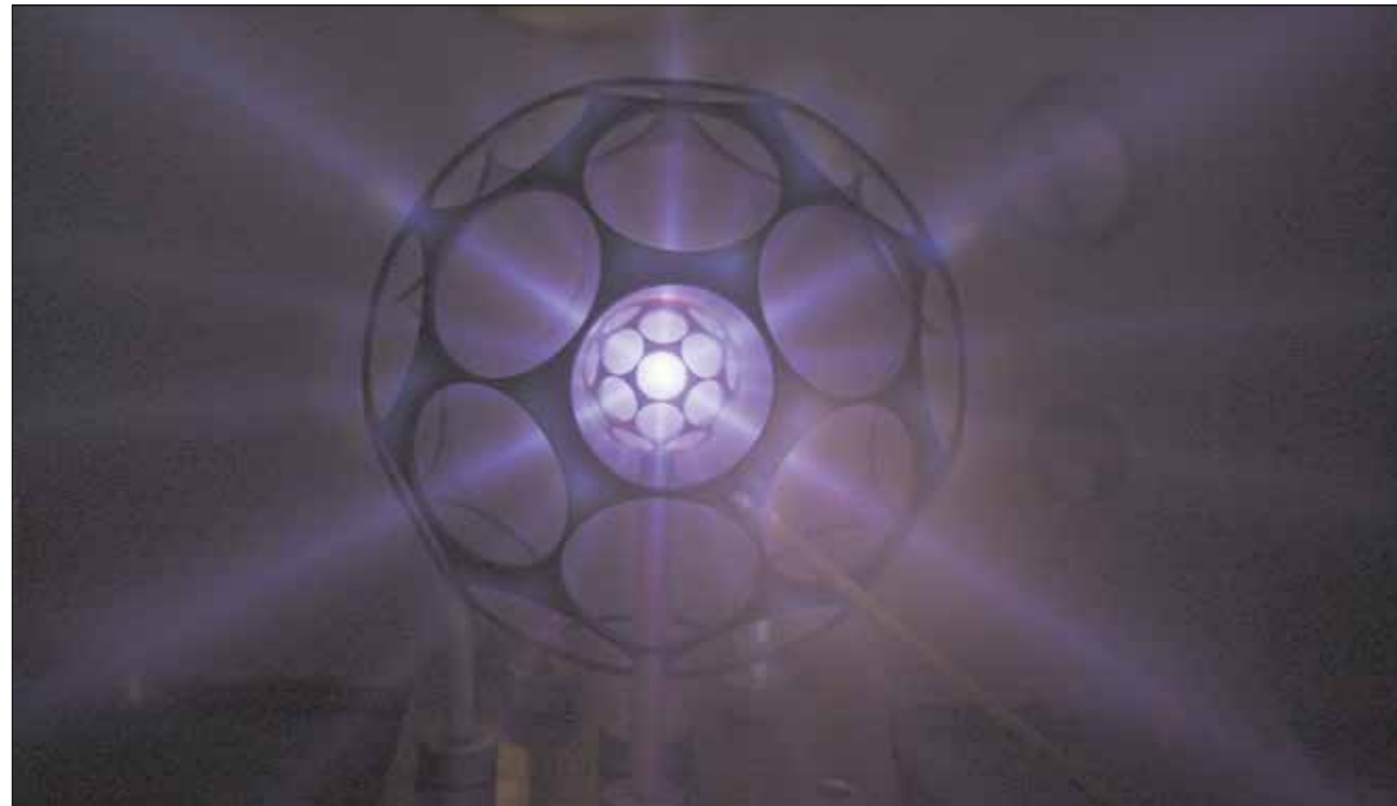
3-D-gedruckte Bucky-Balls leuchten im Sternenmodus. Mit diesen fußballartigen Gebilden wollen die Raumfahrttechniker der TU Dresden eine Kernfusion erreichen. Foto: TUD/ILR
