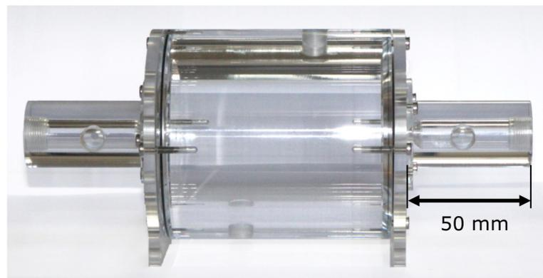
Abbildung 4.6: Gezeigt ist ein Foto des montierten Kapillarrheometers ohne den Anschluss der Fluid Zu- und Ableitungen sowie ohne montiertes Messsystem [119].
