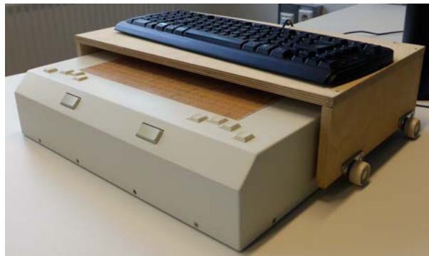
Abbildung 6.2: Prototyp eines bewegbaren Schlittens über der Stiftplatte, auf dem die PC Tastatur platziert werden kann
