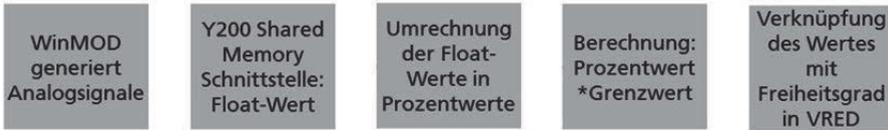
Abbildung 4: Schematische Darstellung der Berechnung von Bewegungsinformationen aus den Analogsignalen einer virtualisierten Anlage
