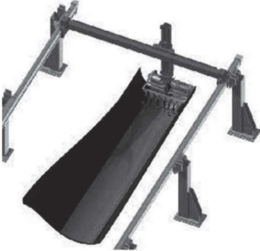
Abbildung 2: Prozess des Ablegens und Drapierens mit der entwickelten Handhabungseinheit
