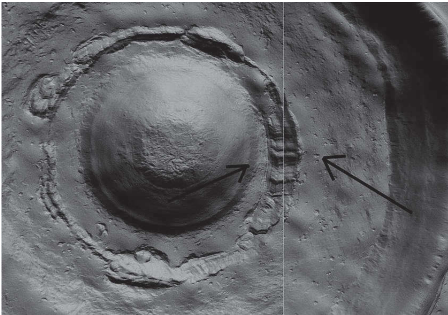
Abbildung 3: Oberflächenstrukturen neben der Schlagbolzenbohrung
