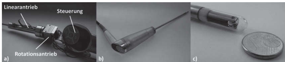
Abbildung4: Endoskop mit schwenkbarer Kamera, a) Antriebe, b) finales Endoskop im Zusammenbau, c) Endoskopspitze mit integrierter Kamera und Beleuchtung, aus (Boese 2016)
