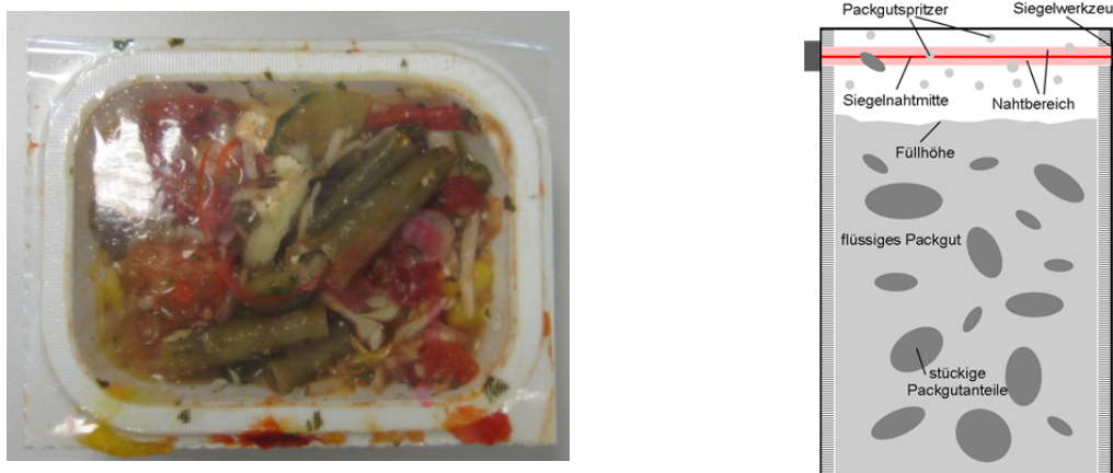
Abbildung 4-3: links) gefüllte Schalenverpackung mit Packgut im Nahtbereich, rechts) Beutelverpackung mit Packgut im Nahtbereich schematisch
