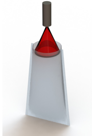
Abbildung 5-10: CAD-Modell des Auftrags flüssiger Störgüter mit Hohlkegeldüse
