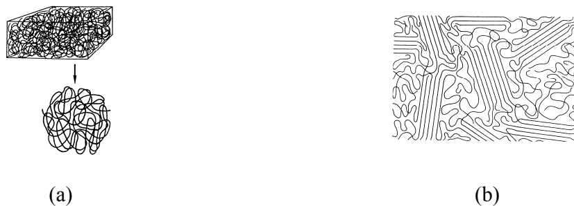
Abbildung 2-2: Schematischer Aufbau und Anordnung der Makromolekülketten bei (a) amorphen und (b) teilkristallinen Thermoplasten [Pot04]
