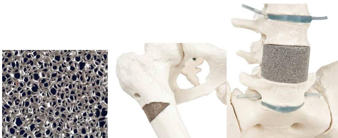
Abbildung 2.4: Metallschäume als Knochenersatzimplantate (Quelle: Modell eines metallischen Implantates, Fraunhofer IFAM Dresden).
