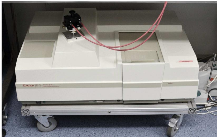
**Abbildung 13:** Cary 5G UV-VIS-NIR Spektrophotometer. Über Lichtleitkabel ist ein Probenhalter in einer Handschuh-Box mit dem Spektrophotometer verbunden.
