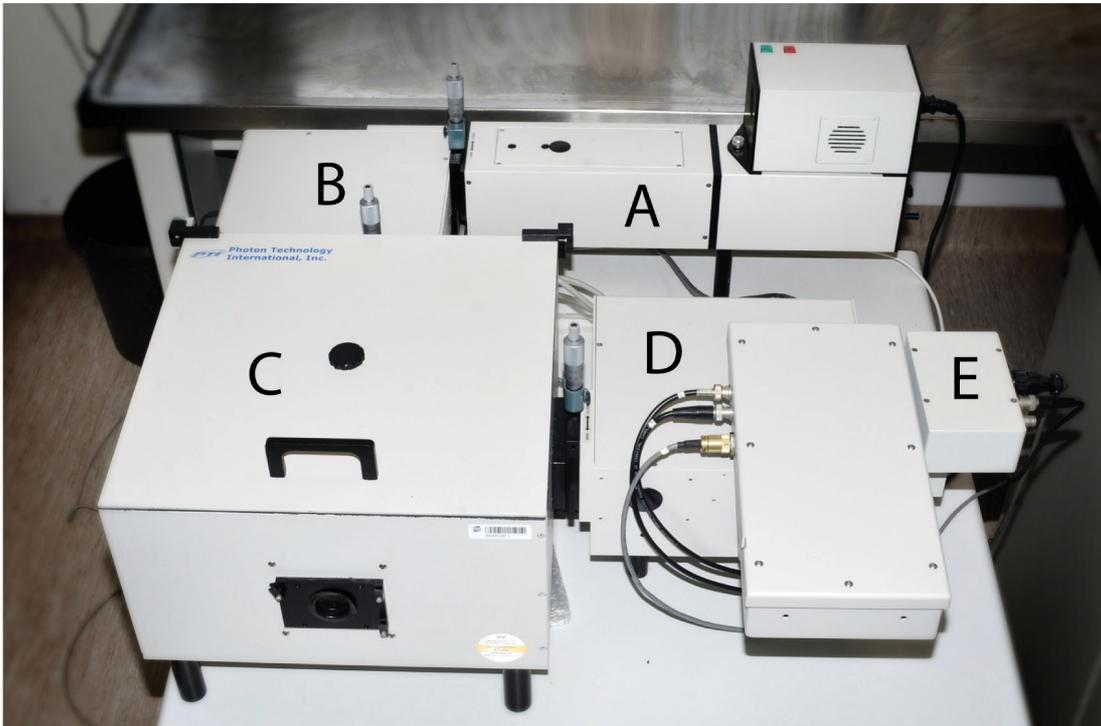
**Abbildung 14:** Aufbau des Fluorometers zur CW-Spektroskopie. A - Xenon-Lichtquelle, B - Anregungsmonochromator mit Stellschrauben für die Spaltweite, C - Probenkammer mit temperierbarem Küvettenhalter, D - Emissionsmonochromator mit Stellschrauben für die Spaltweite, E - Photoelektronenvervielfacher (PMT)
