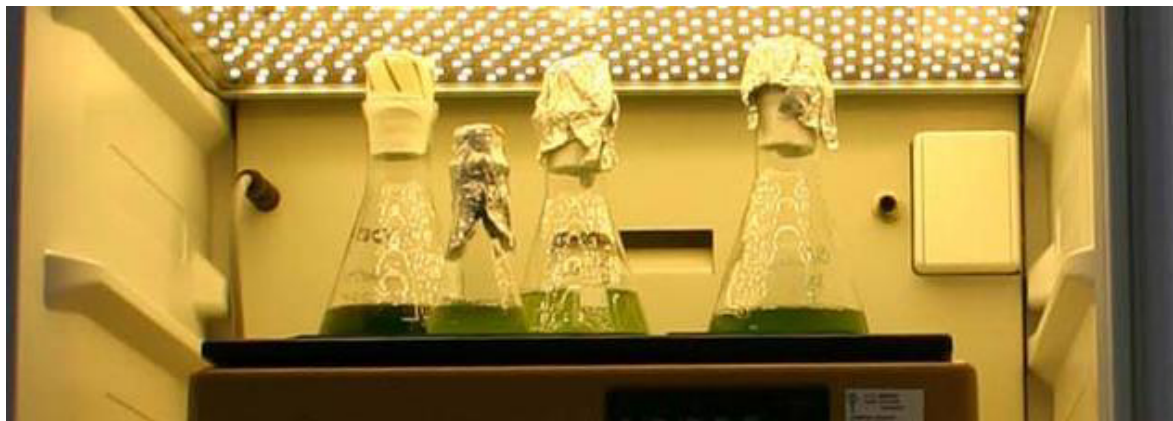
Abbildung 6: AlgaeTron 230 Schüttelkultivierungssystem für phototrophe Organismen von Photon Systems Instruments (psi.cz).
