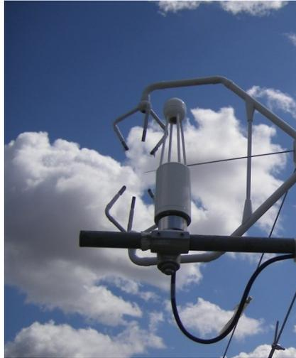
Abbildung 4-4: EC-Messsystem bestehend aus *open-path* Gasanalysator (LI-7500) und Ultraschallanemometer (CSAT3)
