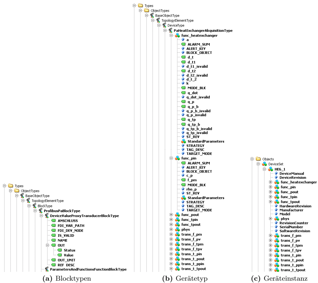
Abbildung 4.19: Struktur des Apparate-Informationsmodells (zur Übersichtlichkeit wurden Nodes entfernt)
