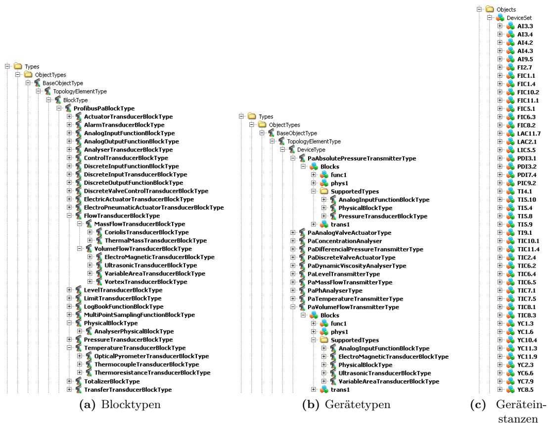
Abbildung 4.6: Struktur des Geräte-Informationsmodells (zur Übersichtlichkeit wurden Nodes entfernt)
