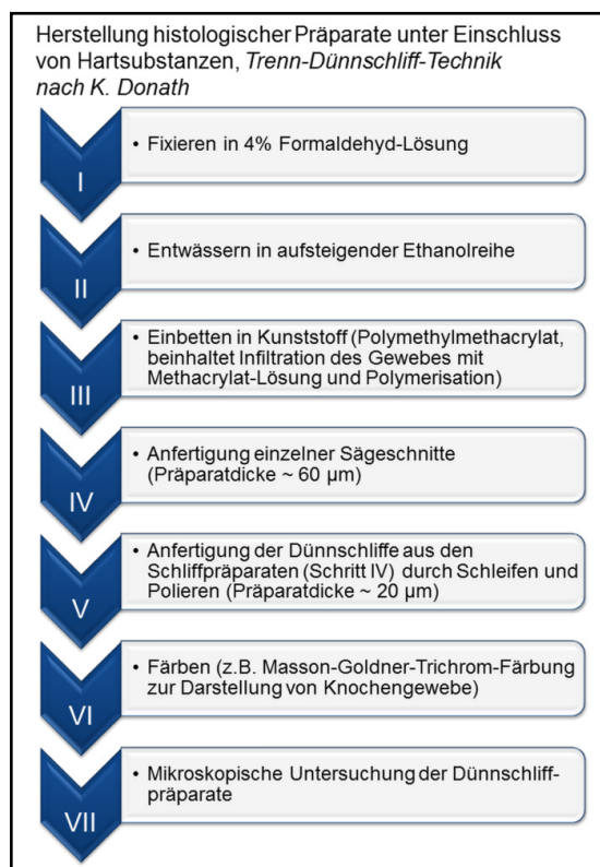
Abb. 5 Darstellung der Arbeitsschritte zur Anfertigung gefärbter Dünnschliffe, nach 169,171,173 .
