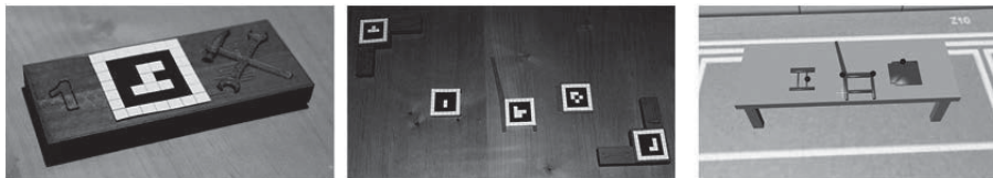
Abbildung 5: Darstellung des Assembly-Targets (Links) sowie des Assembly-Rectangles (Mitte) und der dazugehörigen virtuellen Darstellung (Rechts).
