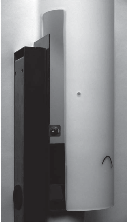
Abbildung 3: "Das Problem": mundgeblasenes Überfangglas, eingeschliffener Schlitz, gebohrte Löcher und einzeln anzupassende Glashalterung. Mit Edding markiert: Fehler im Glas. (Glas wird eigentlich über das Blech geschoben und von hinten an die Halterung geschraubt.)
