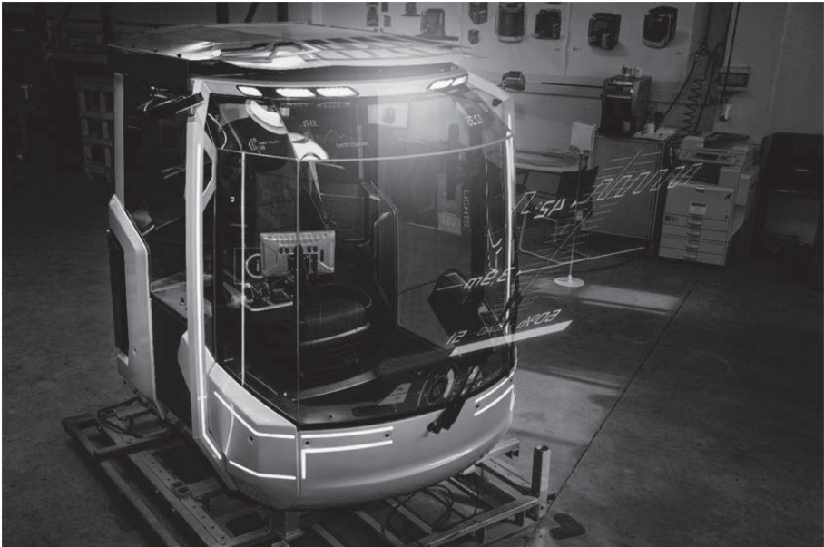
Abbildung 5: Darstellung der virtuell implementierten HMI-Komponenten
