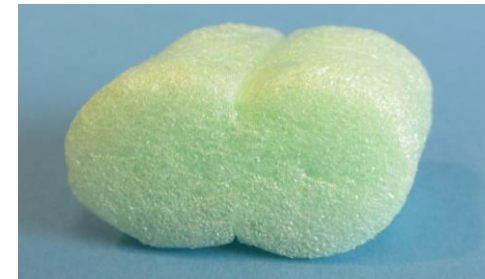
Füllmaterial aus Polystyrol, durch Mikroorganismen abbaubar
