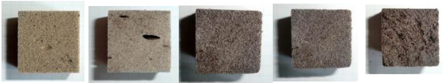
Schäumen in Form - anschließend besäimt PUR + Lignin (Ligninanteil steigend)
