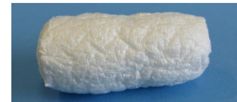
Füllmaterial aus Maisstärke, wasserlöslich, biol. abbaubar
