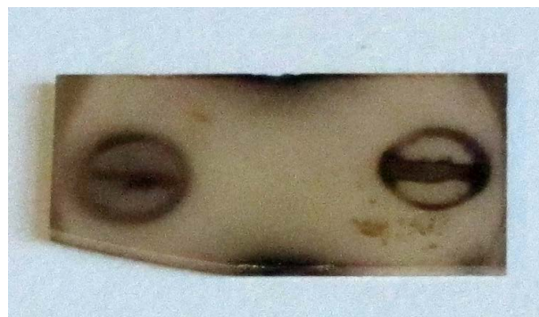
Abbildung 4.10.: Verfärbungseffekt eines bei 800 °C für 5 min getemperten LN Substrates
