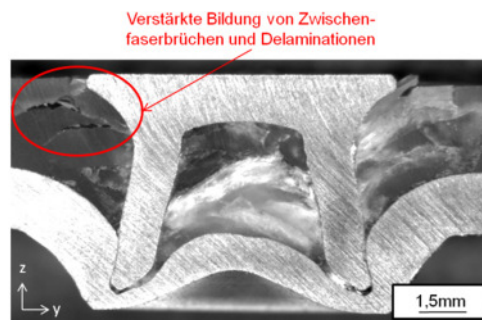
Abbildung A.XIX: Mikroschliff Verbindungsausbildung beim HSN für die Imperfektion „Fasergasse“
