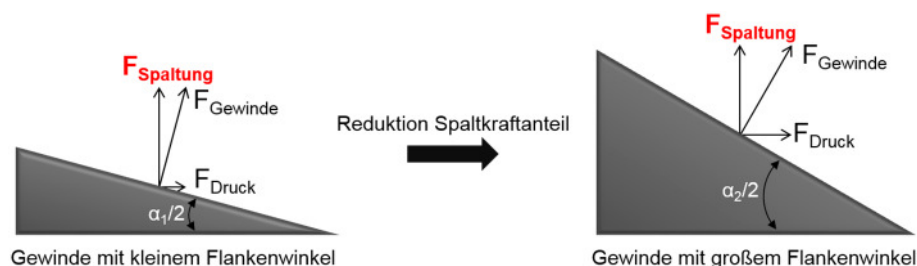
Abbildung 4-20: Wirkende Gewindekräfte bei unterschiedlichem Flankenwinkel [WFF+13]
