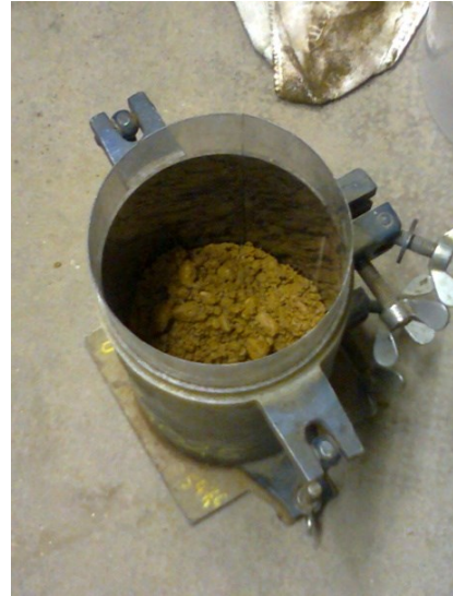
Abbildung 4-5: Stahlzylinder und Kunststoffinnenzylinder sowie eingefülltem Untersuchungsmaterial
