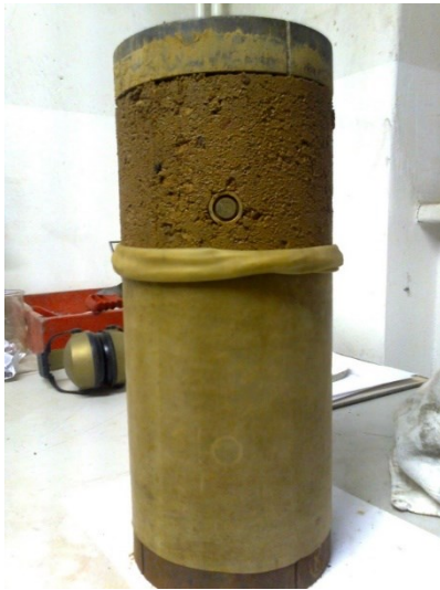
Abbildung 4-9: Fertiger Probekörper und Latexmembran vor dem Einbau in Triaxialzelle
