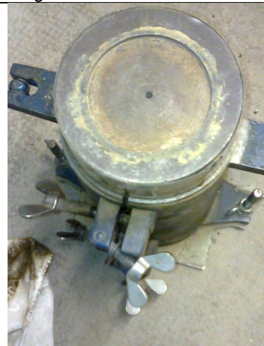
Fertig hergestellter, eingeschalteter Probekörper
