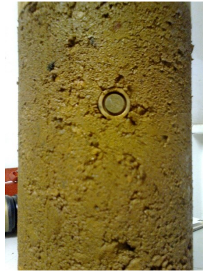
Abbildung 4-10: Fixierter Magnet der oberen Messebene im Probekörper
