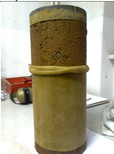
Probekörper für triaxiale Prüfung mit Magneten in Latexmembran
