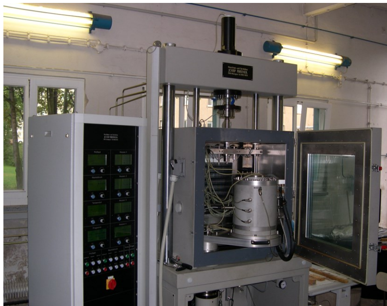
Abbildung 4-1: Triaxialprüfstand der TU Dresden, Institut für Stadtbauwesen und Straßenbau, Professur für Straßenbau
