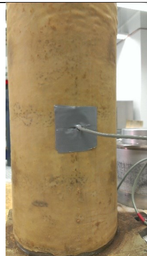
Probekörper für Temperaturmessungen mit Messfühler und Latexmembran
