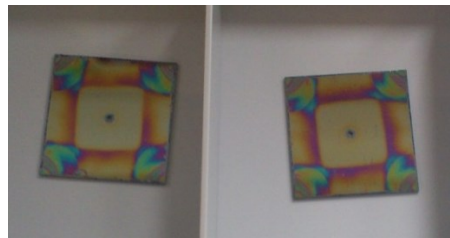
Abbildung 82: Siliziumwafer nach Beschichtung mit Copo(1c)-1 (HEMA/ECPPA-Copolymer, 50/50 mol%), LM: Methanol).
