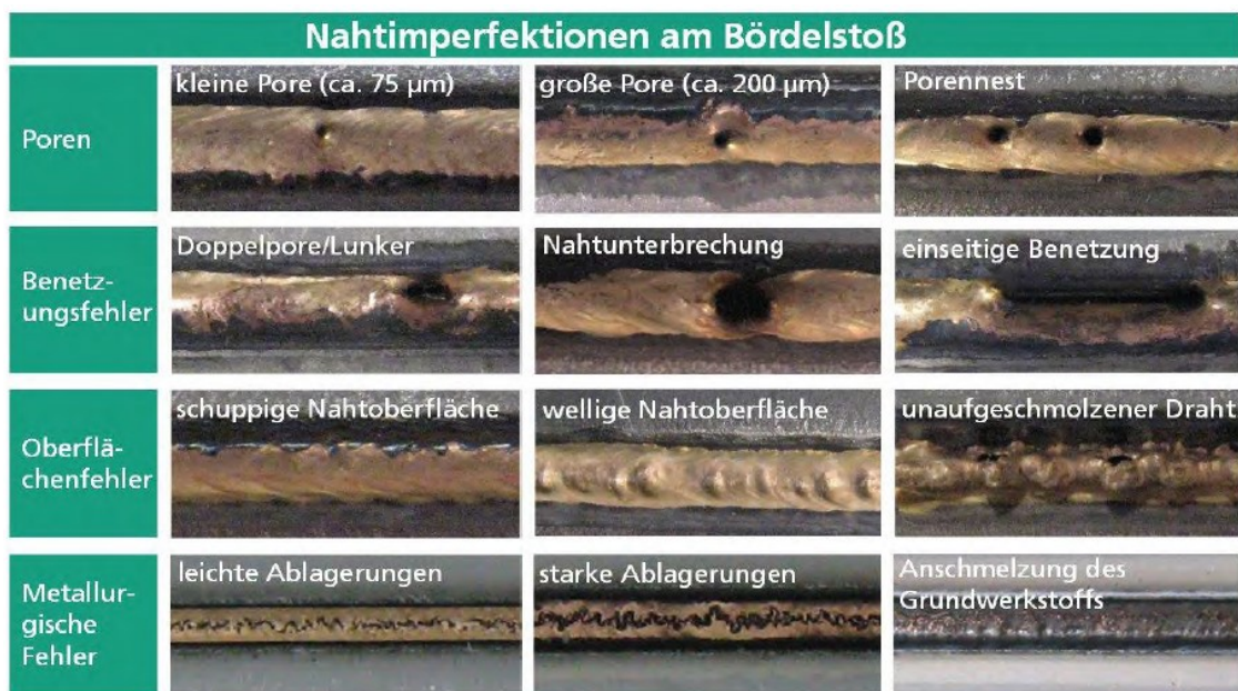
Abbildung 2.21 Art und Ausprägung unterschiedlicher Imperfectionen am Bördelstoß [EQOS11]
