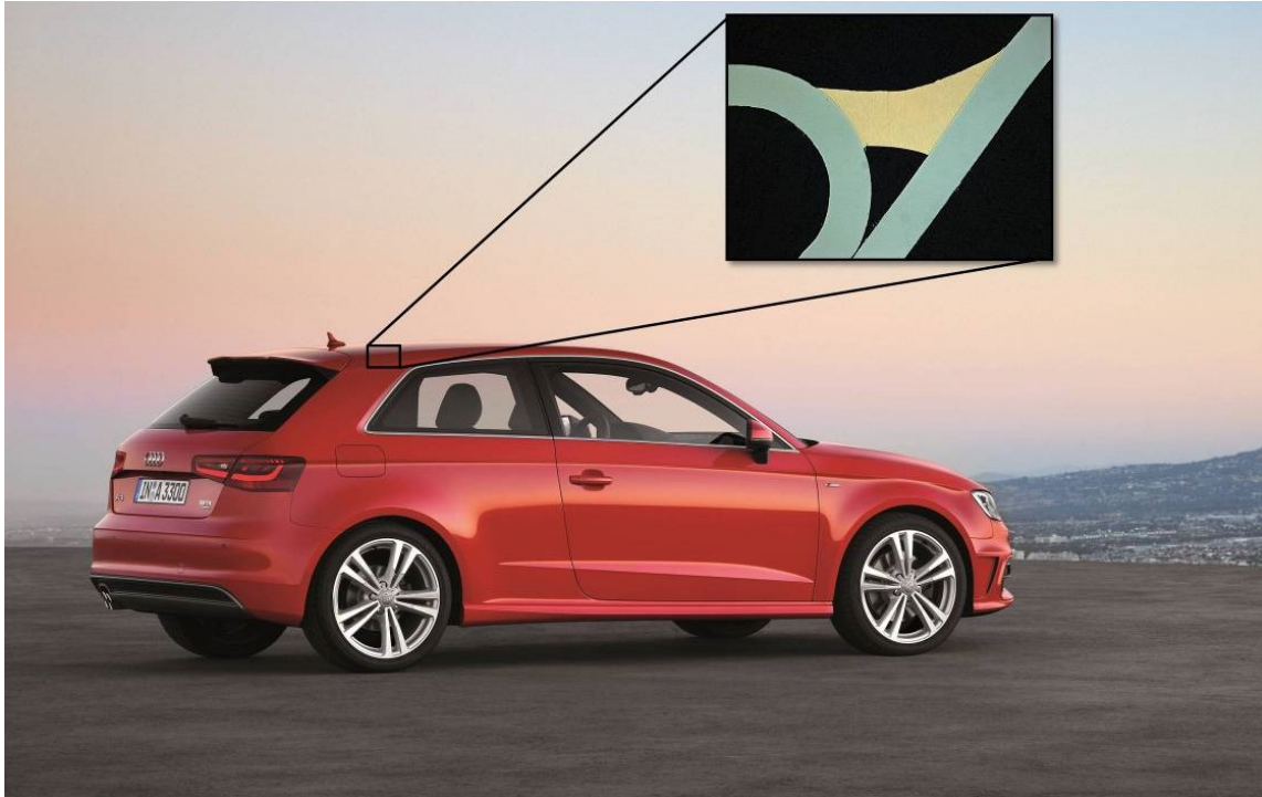
Abbildung 1.1 Laserstrahlgelötete Dachnaht beim aktuellen Audi A3 [Grau12]
