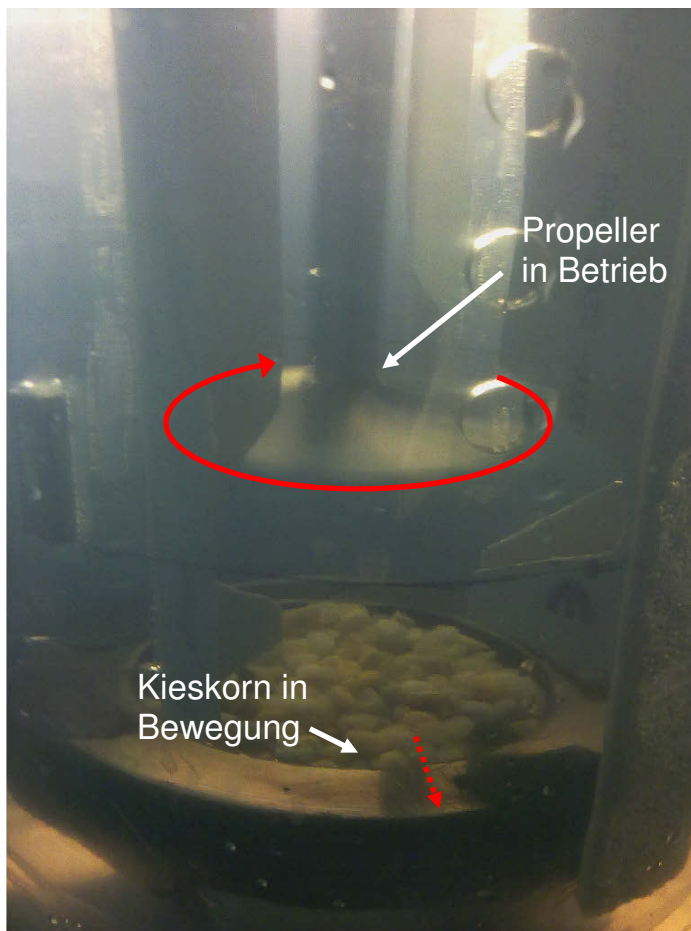
Bild 5-4: Beispielhafte Aufnahme der Kalibrierung für den Korndurchmesser D_m = 6,0 mm.
