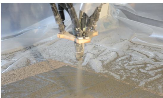
Bild 4: Spritzbetonapplikation und experimentell ermittelte Spritzstreifen
