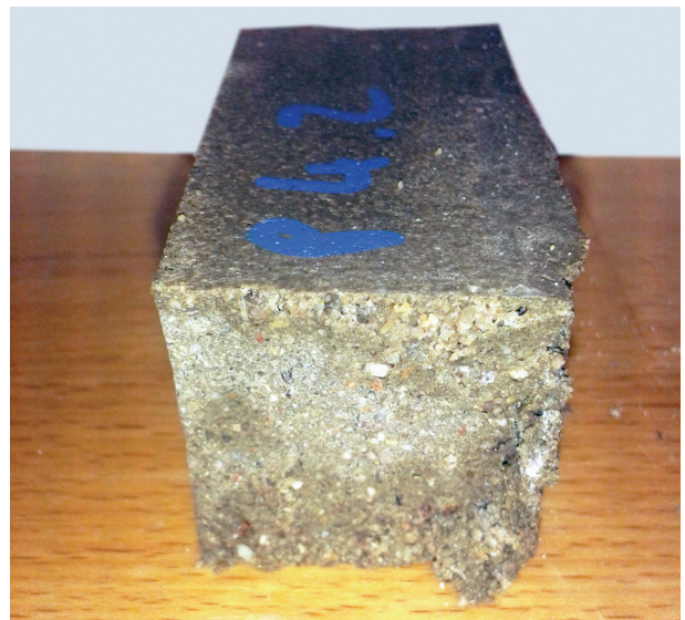
Bild 2: Probekörper mit ungleichmäßigem Gefüge [Foto: T. Sören Sippel]
