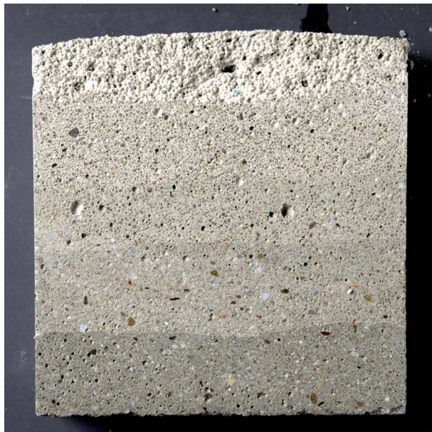
Bild 4: Bauteilquerschnitt eines gradierten Betonbal-kens, hergestellt im Schichtverfahren [Foto: ILEK/ Gabriela Metzger]
