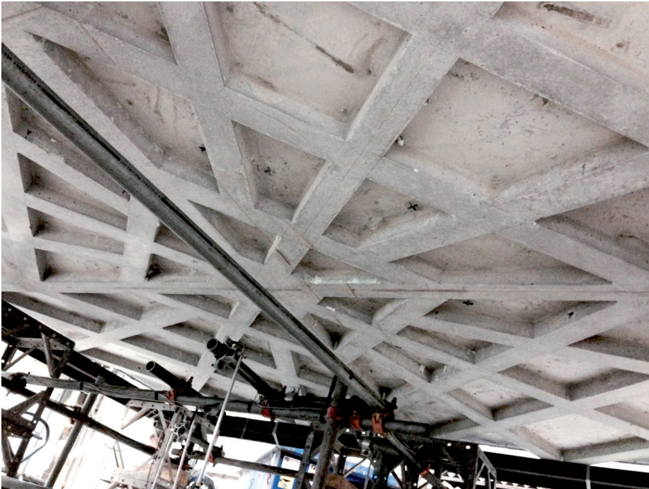
Bild 8: Rippendecke mit Messgestell im Prüffeld des IfM
