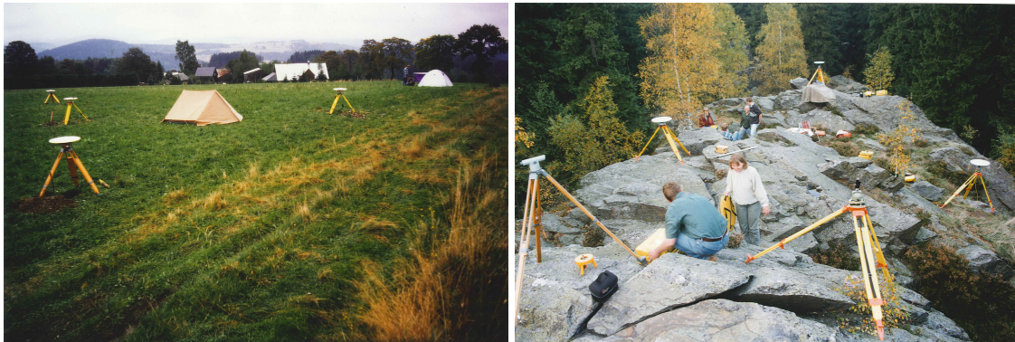
Abbildung 9: GPS-Messungen im sächsischen Vogtland. Linkes Bild: Beobachtung der unterirdisch vermarkten Festpunkte. Der Hauptpunkt wurde mit mehreren Sicherungspunkten abgesichert. Rechtes Bild: GPS-Beobachtungen auf der Station Wendelstein bei Grünbach. Von links nach rechts im Vordergrund: Jens Wendt und Monika Sonntag. Im Hintergrund: Anja Wendt, Axel Rülke, Waldemar Schneider und Lutz Eberlein.
