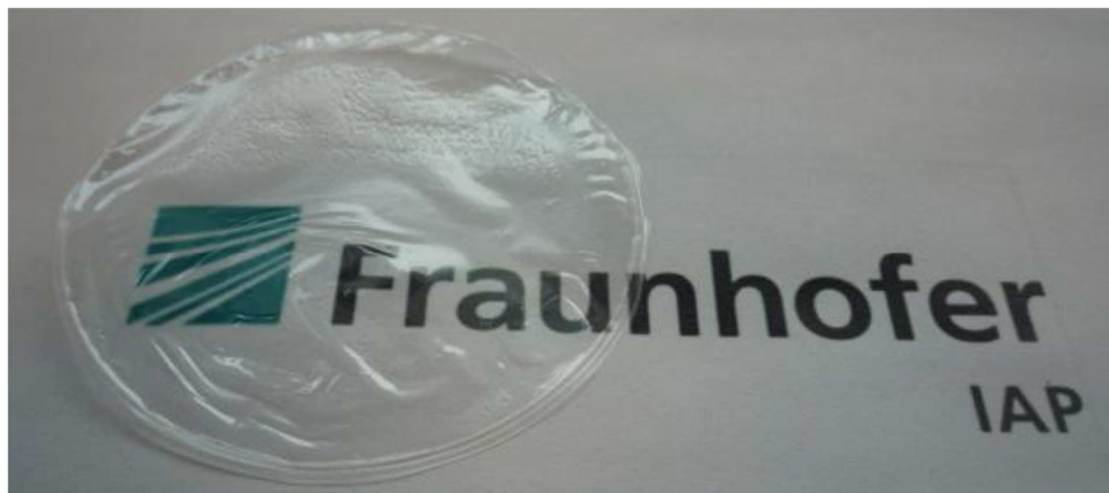
Abbildung 39 Folie aus dem Polyelektrolytkomplex Celluloseethersulfat/polyDADMAC (Probe 12-Sul-79 und polyDADMAC I).
