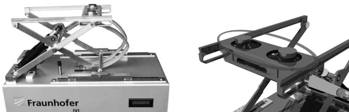
Abbildung 4.5: Scherenhub mit Spindelantrieb für Fahrzeuge ohne Pantograph (links: Gesamtansicht, rechts: Detailausschnitt Elektromagneten)
