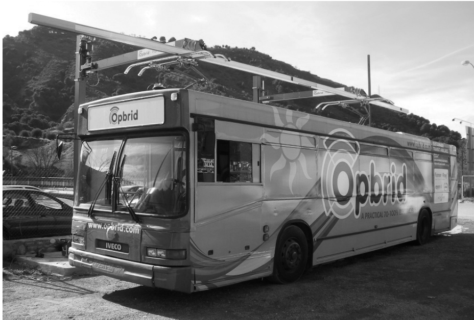
Abbildung 2.2: Opbrid-Bus und Nachladesystem Opbrid Búsbaar™ [205]
