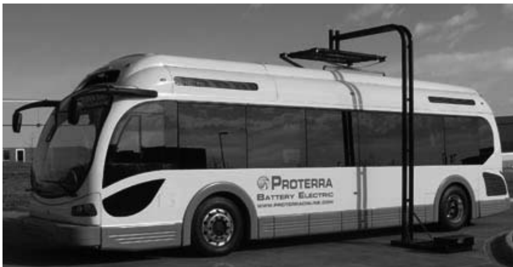
Abbildung 2.3: Proterra-Bus und Nachladesystem FastFill™ Charging Station [66]
