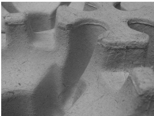
Abb. 5: Fasergussverpackung mit Miscanthus; obere Ansicht
