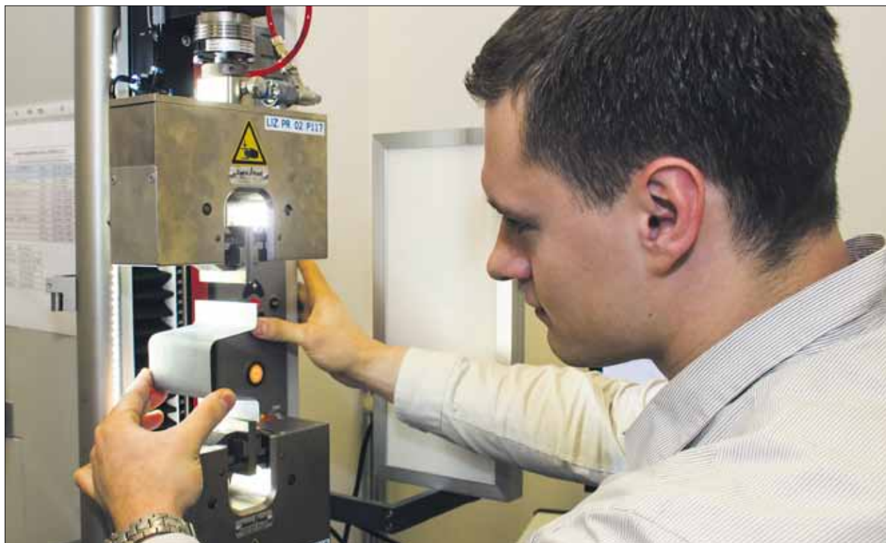
Im LEIKA-Projekt testet ILK-Wissenschaftler Tino Wollmann verschiedene Sandwichwerkstoffe auf ihre Eigenschaften. Hier misst er die Federsteifigkeit, den Widerstand des Werkstoffes gegen Verformung bei Krafteinwirkung. Foto: Tanja Kirsten
