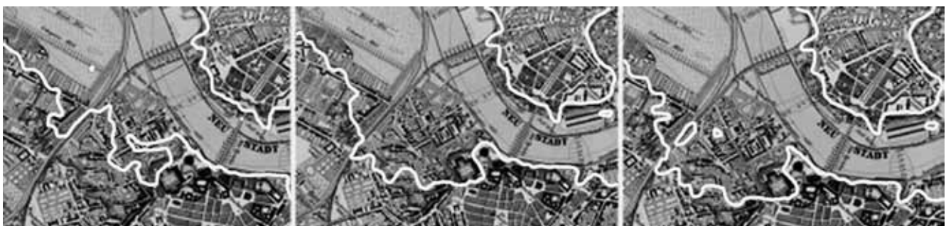
Bild 3: Vergleich der Überschwemmungslinien (weiß) in der Nähe des Pegels Dresden anhand der historischen Karte mit modellierten Abflüssen von 4\,300\text{ m}^3/\text{s} ( 111,65\text{ m ü. NN} , links), 4\,700\text{ m}^3/\text{s} ( 112,2\text{ m ü. NN} , Mitte) und 4\,500\text{ m}^3/\text{s} ( 111,80\text{ m ü. NN} , rechts)
