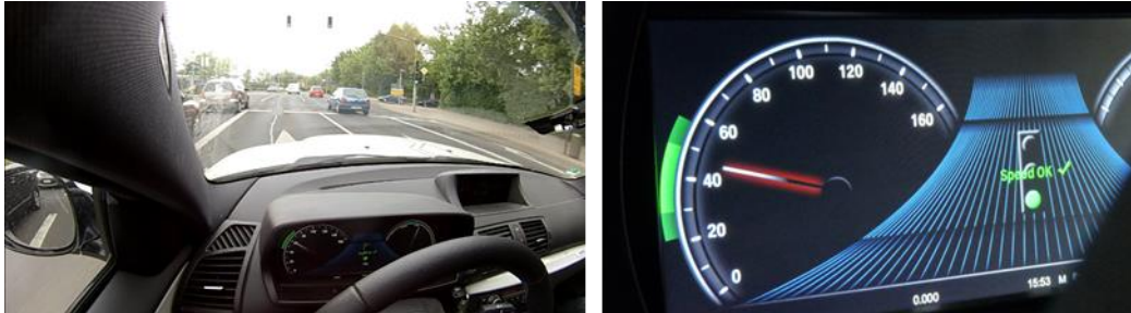
Abbildung 63: Darstellung einer im Projekt EFA 2014/2 umgesetzten Anzeigenvariante zur Empfehlung von effizienten Geschwindigkeitsbereichen an LSA-gesteuerten Knotenpunkten
