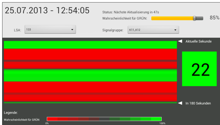
Abbildung 29: Schaltzeitprognose auf Basis von Wahrscheinlichkeitsvektoren
