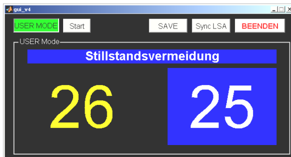
Abbildung 6-3: Darstellung des Anzeigekonzeptes (GUI) im Versuchsfahrzeug – oben: Anzeige der aktuellen Strategie; links: aktuelle Fahrgeschwindigkeit; rechts: Richtgeschwindigkeit.
