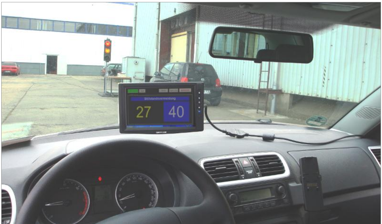
Abbildung 6-5: Sicht aus dem Cockpit des Versuchsfahrzeugs auf LSA und Display (mit HMI)
