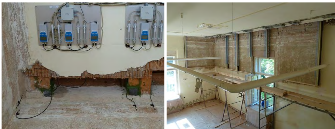
Abb. 9 Zellulose-Messfeld mit abgedichteten Holzfeuchtesensoren (,HF-St'), kombinierten Luftfeuchte / Temperaturfühlern (,ID') und Montageplatten mit der Messelektronik
