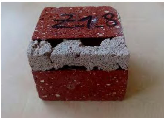
Abb. 102 Mauerwerksausschnitt mit nur teilweise aufgefüllter Mörtelfuge
