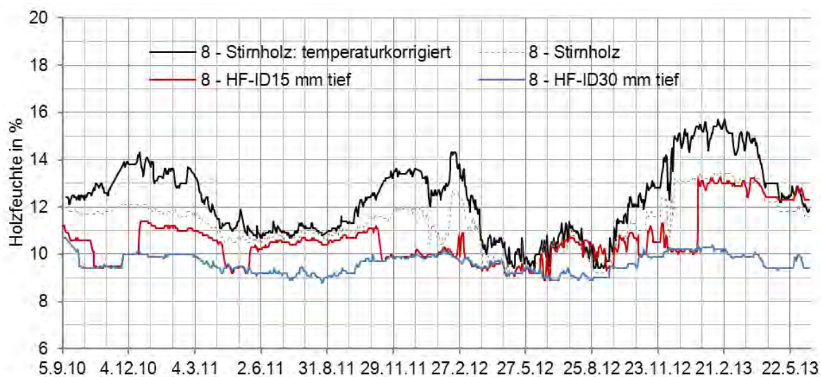
Abb. 70 Gemessene Holzfeuchte an (Referenz-)Balken 8 am Stirnholz und in zwei unterschiedlichen Tiefen (15 und 30 mm) auf der Ebene der Bestands-oberfläche; grau-gestrichelt der nicht-temperaturkorrigierte, tatsächlich gemessene Verlauf der Holzfeuchte am Stirnholz
