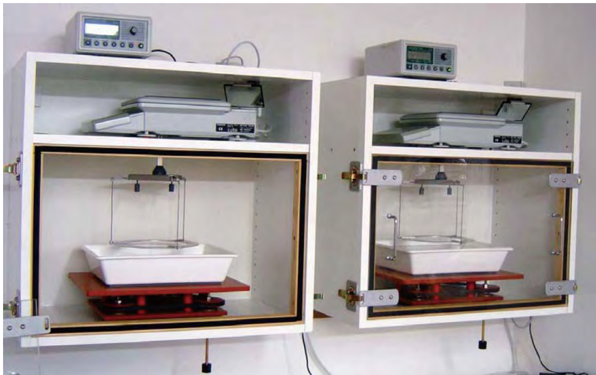
Abb. 36 Automatische Messapparatur zur Bestimmung der kontinuierlichen Wasseraufnahme und der kapillaren Sättigung von kapillar-porösen Baustoffen.
