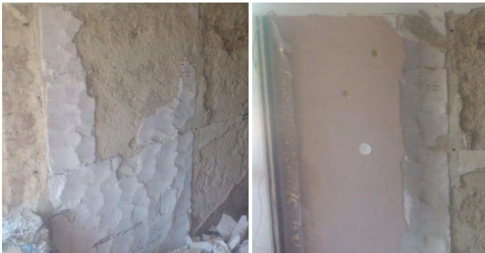
Abb. 27 Abbruch der Perliteplatte: die einzelnen Abscherflächen in der Kleber- und Dämmschicht des Spatens sind links gut zu erkennen
