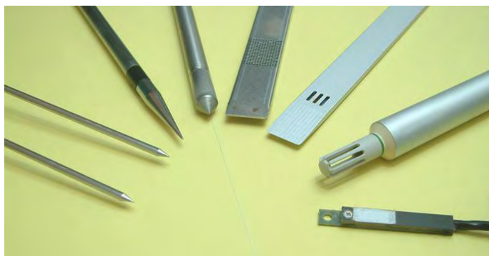
Abb. 5 Spezielle Sensoren zur Holzfeuchtemessung (1.+ 2. von links) und für die Luftfeuchte- und Temperaturmessung
