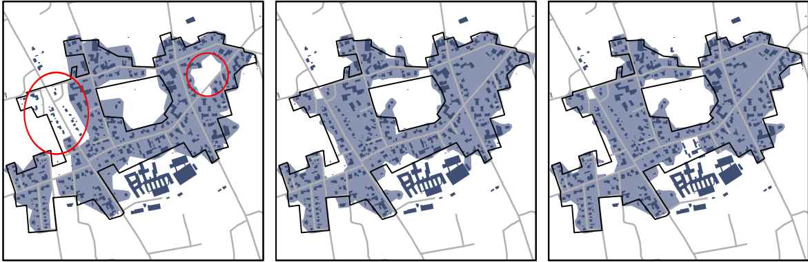
Abbildung 5.3: Abgrenzungsbeispiel für die Untersuchungsansätze 2.1 Selektion, Pufferung und Löcherschließen (links), 2.2 Selektion, Pufferung, Urbanitätsindex und Löcherschließen (Mitte) und Selektion mit verbesserter Ortslage, Pufferung und Löcherschließen; Referenz als schwarze Linie, Abgrenzungen hellblau, Straßen grau, Hausumringe dunkelblau
