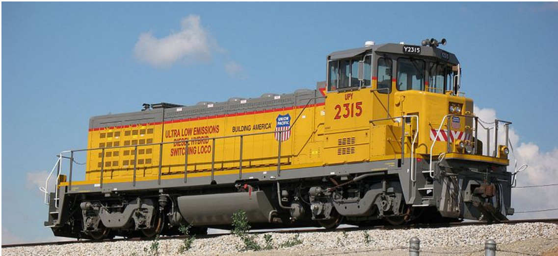
Abbildung A.5: Hybrid-Rangierlok Railpower GG-20B („GreenGoat“) der Union Pacific (Foto: Bryan Flint, Quelle: wikipedia.org)
