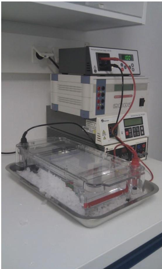
Abb. 3: Agarose-Gelelektrophorese mit Elektrophorese- und Stromversorgungseinheit
