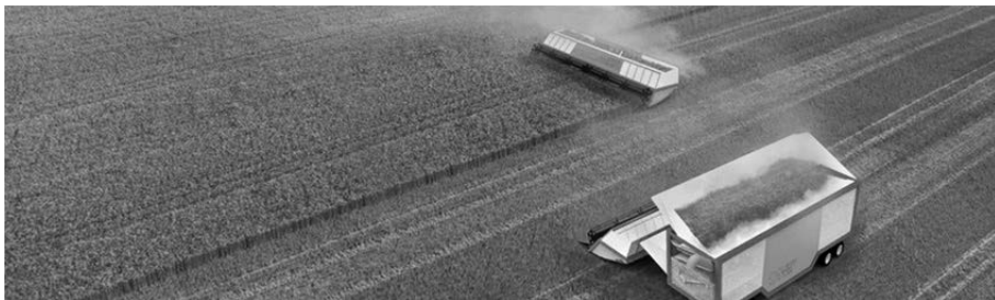
Abbildung 5: Autonomer Mähbalken arbeitend auf dem Feld mit am Feldrand befindlicher Drescheinheit (Wolf 2011)
