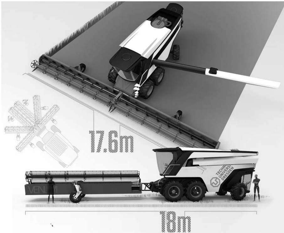
Abbildung 7: Darstellung des VENUM Mährescherkonzepts in Ernte- und Transportposition (Schreiber 2013)
