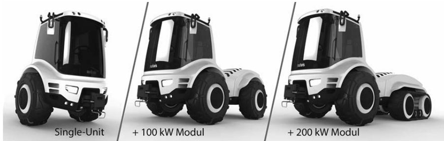
Abbildung 9: Modulare Traktorkonfiguration zur Leistungsanpassung der Maschine an die jeweilige Arbeitsanforderung (Pahner 2013)
