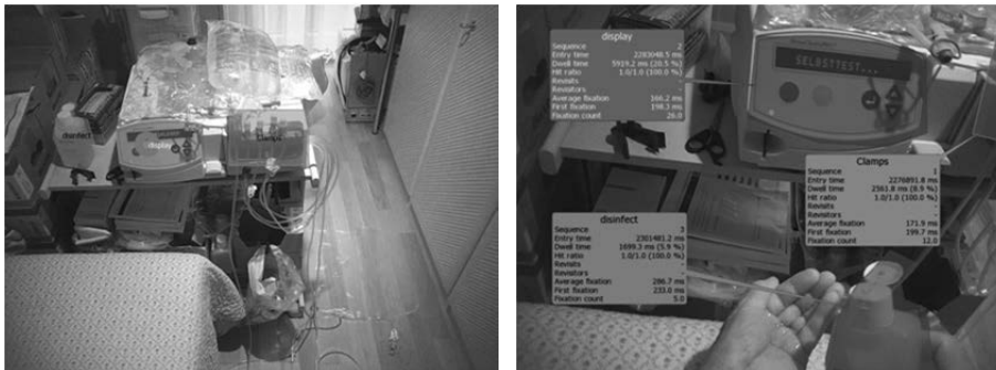
Abbildung 4: Eye Tracking Video vom Patient in der Heimdialyseanwendung; eingearbeitete dynamische AOIs (links) mit eingeblendeten Messwerten (rechts)
