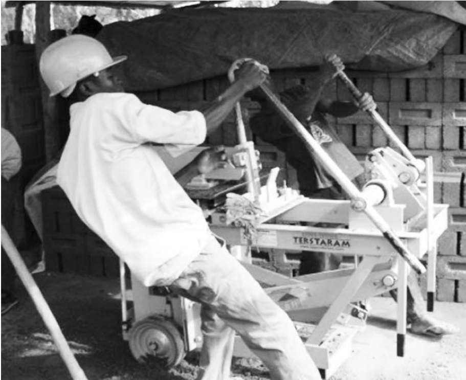
Abbildung 8: Manuelle Lehmsteinpresse Terstaram
