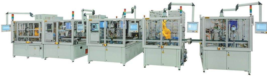
Roboterassistierte Montage mechatronischer Systeme
