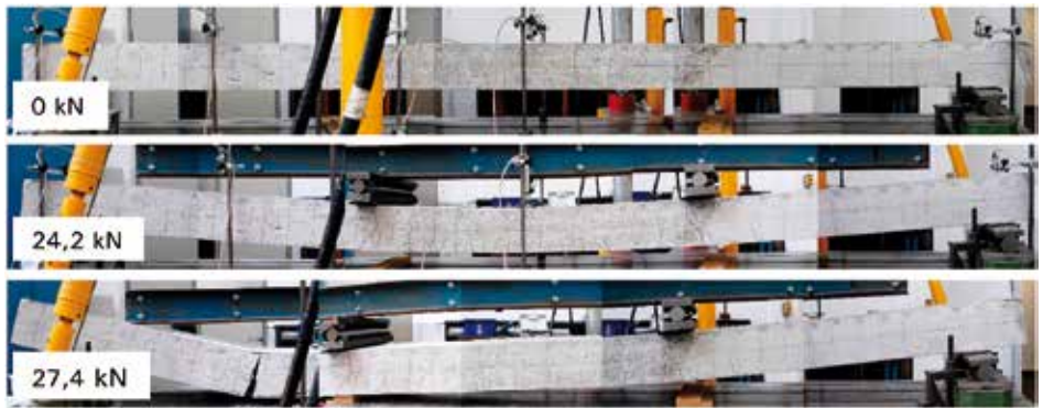
Bild 9: Prüfaufbau und Lastschritte beim Vierpunkt-Biege- versuch [Fotos: ILEK / Michael Herrmann]
