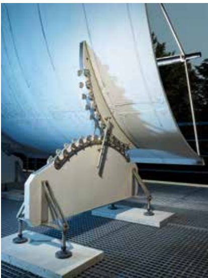
Bild 3: Auflagerung des Demonstrators [Foto: Thomas Brenner]
