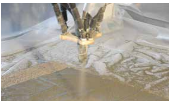
Bild 4: Spritzbetonapplikation und experimentell ermittelte Spritzstreifen
