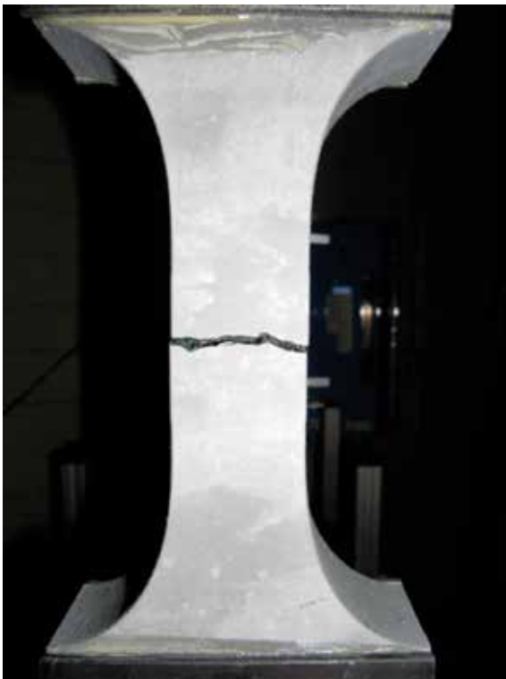
Bild 7: Gerissener Probekörper nach zentrischem Zugversuch [Foto: Sandy Illguth]
