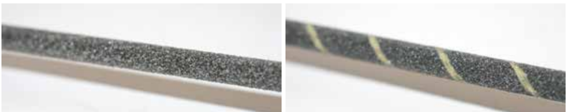
Bild 6: CFK-Stab mit Quarzsand (links) und mit zusätzlichem Kunststoffband (rechts) [Fotos: Michael Henke]
