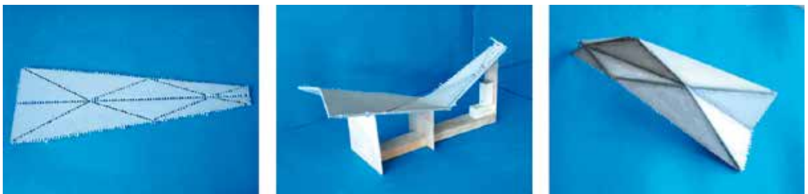
Bild 9: Herstellung des Oridome im Modellmaßstab: Platte mit Faltmuster (links); manuelle Faltung mit Hilfe einer Unterstützungskonstruktion (Mitte); fertiges Segment nach der Verfugung der Faltkanten (rechts) [16]
