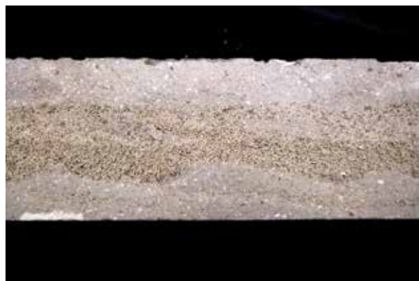
Bild 5: Bauteilquerschnitt eines gradierten Betonbal-kens, hergestellt im Trockenspritzverfahren [Foto: ILEK/Gabriela Metzger]
