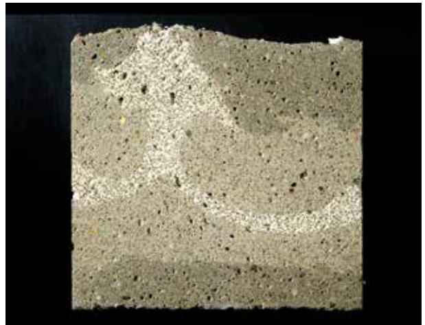
Bild 1: Auftrieb einer leichten Betonmischung beim Nassauftrag [Foto: Gabriela Metzger]
