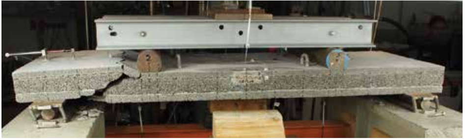
Bild 6: Geschichtete Deckenplatte aus konstruktivem Leichtbeton LC20/22 und Infra-leichtbeton im Vierpunktbiegeversuch mit Schubversagen
