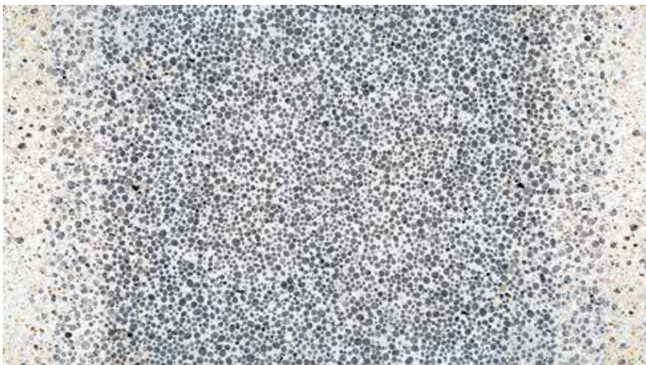
Bild 2: Schnitt durch eine Wand mit funkti- onal gradiertem Wandaufbau [Foto: ILEK / Gabriela Metzger]
