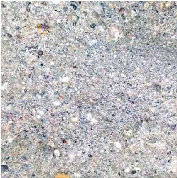
Bild 7: Probekörper mit homogenem Aufbau [Foto: T. Sören Sippel]
