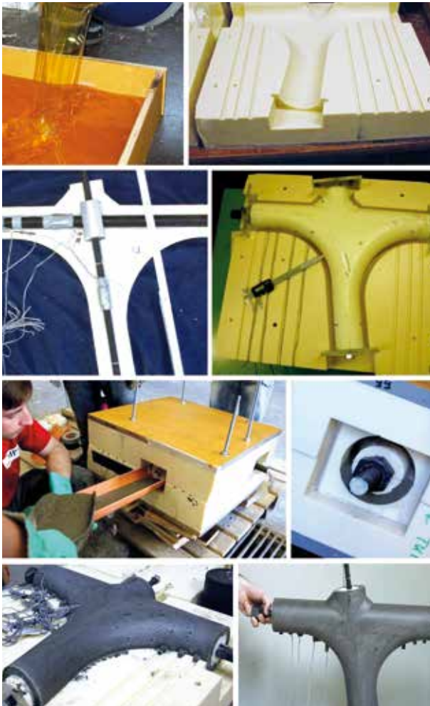
Bild 9: Herstellung der Knotenelemente, von oben nach unten: Fertigung der Außenschalung des Knotens bestehend aus Wachs, Polystyrol-Innenkern mit Spanngliedern und dies in der Außenschalung montiert, Betonieren des Knotens, wobei stetig die Steighöhe des Betons optisch kontrolliert wurde und Ausschalen des fertigen leichten UHPFRC-Knotens [5] [Quelle: ITE & iBMB]
