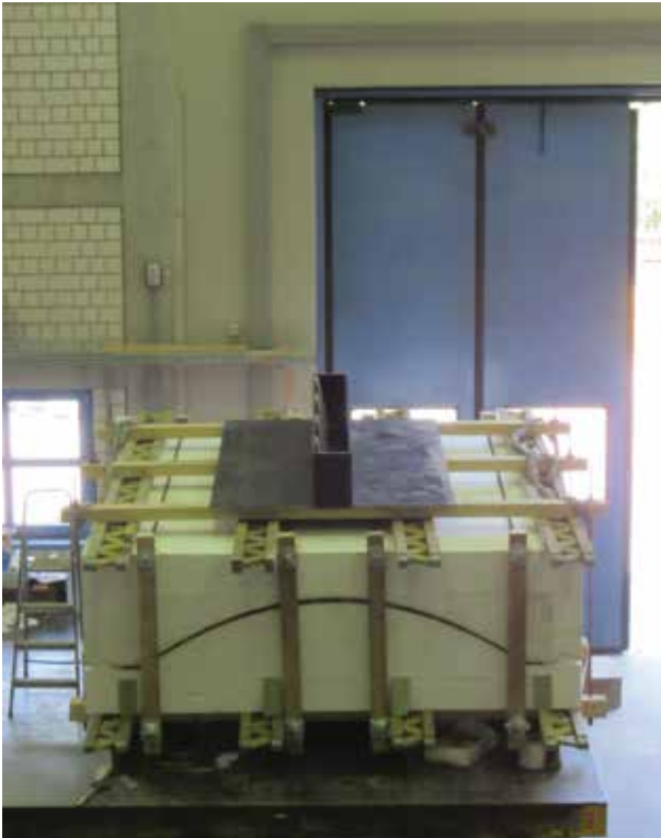
Bild 6: Betonierfertige Schalung im Labor für Konstruktiven Ingenieurbau der TU Kaiserslautern [Foto: Sören Müller]
