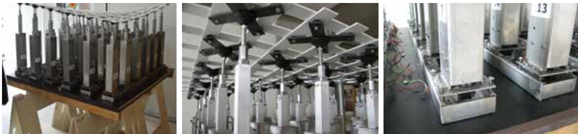
Bild 7: Das aus dem Forschungsvorhaben VOLLERS & RIETBERGEN der TU Delft [10] hervorgegangene Funktionsmodell, das links zu sehen ist, wird umgebaut und als Versuchsträger genutzt. Es wurden Arme zur Spannweitenverkürzung nachgerüstet und es erfolgte ein Umbau hin zu schwenkbar gelagerten Aktuatoren. [Fotos: Ulrich Knaack]
