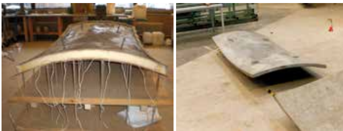
Bild 4: oben: Patent-Skizzen von Adapa ApS. (Patent US 20130299084 A1); unten: Forschung von SCHIPPER (TU Delft) an Betontechnologie für adaptive Formtische [Fotos: Roel Schipper]
