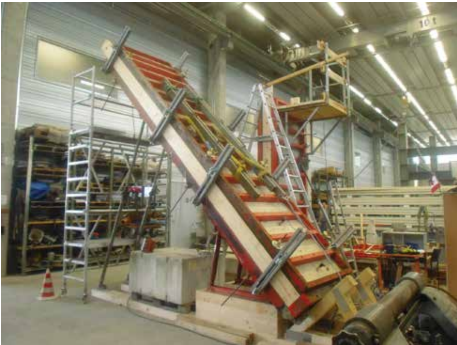
Bild 1: Versuchstand für die Betonierversuche; im Vordergrund: geneigtes Schalungssystem, im Hintergrund: lotrechtes Schalungssystem [Foto: Björn Freund]
