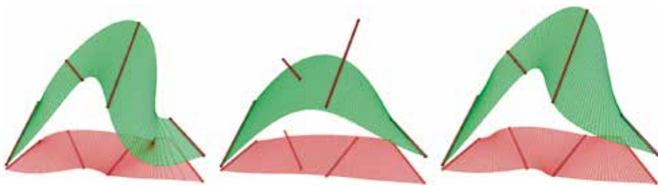
Bild 5: Subdivisionsalgorithmen für vier Geraden (AITKEN, BÉZIER, B-Spline)
