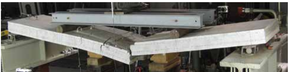
Bild 9: Durchriss der Stahlbewehrung (Biegezugversagen) einer 2,50 m langen, geschichteten Platte aus Normal- und Porenleichtbeton
