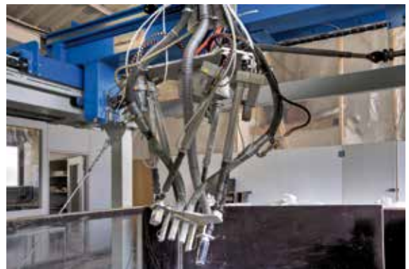
Bild 2: Portalsystem zur Realisierung der Düsenführungs- bewegung und STEWART-GOUGH- Plattform zur Realisierung der Düseneigenbewe- gung und Düsenori- entierung [Foto: Gabriela Metzger]
