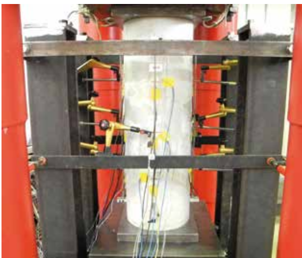
Bild 12: Versuchsaufbau und Messtechnik für die exzentrischen Druckversuche [Foto: Daniel Busse]
