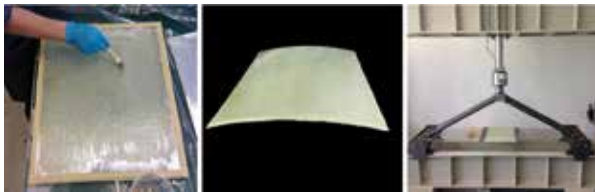
Bild 3: Herstellung eines Schalungssegmentes, fertiges vorgekrümmtes Segment und Aufbringen einer Zugbelastung im ABD-Strukturprüfstand [Fotos: Carolin Petzoldt]
