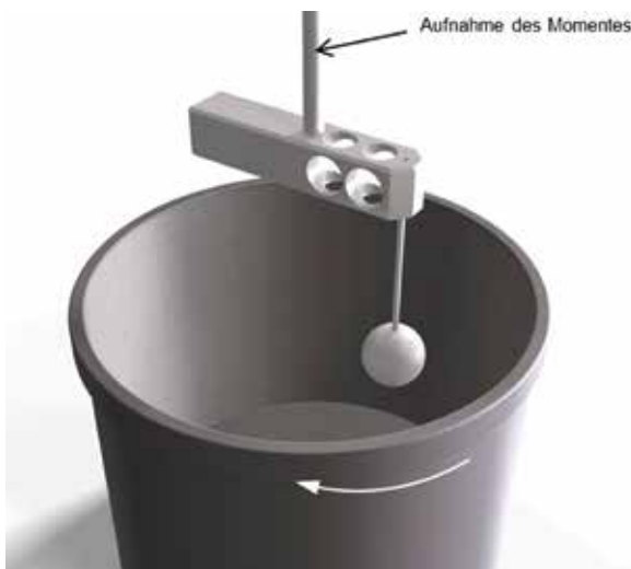
Bild 9: Kugel-Mess-System für Rotationsrheometer [Quelle: Fa. Schleibinger [13]]
