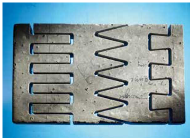
Bild 2: Unterschiedliche Fugengeometrien, mittels Hochdruckwasserstrahl geschnitten
