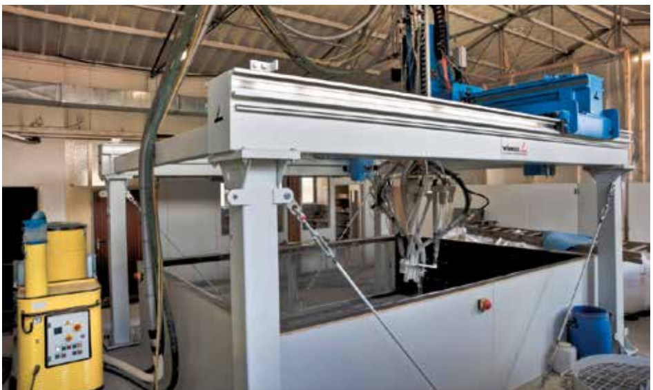
Bild 7: Mehrachs-Manipulator mit Hexapod und Spritzdüsen [Foto: ILEK / Gabriela Metzger]
