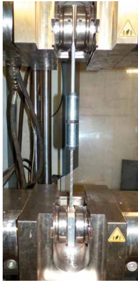
Bild 9 (links): Zugversuch an einem CFK-Stab mit Klemmver- ankerung [Foto: Michael Henke]
