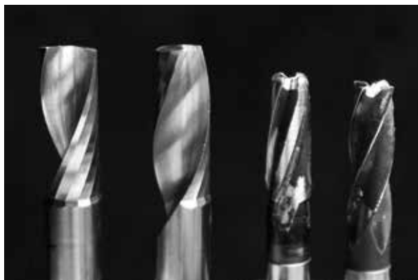
Bild 3: Von links nach rechts: genutzter Vollhartmetall-Fräser, ungenutzter Vollhartmetall-Fräser, genutzter Schnellschnittstahl-Fräser, ungenutzter Schnellschnittstahl-Fräser
