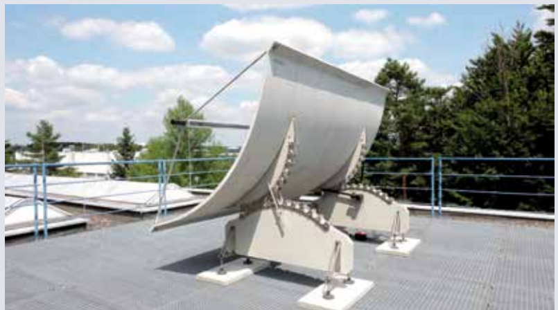
Bild 17: Der Parabolrinnen-Großdemonstrator aus UHPC verdeutlicht eindrucksvoll die Leistungsfähigkeit heutiger Betone
