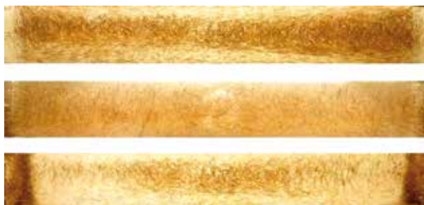
Bild 5: Einfluss der Rotationsgeschwindigkeit auf die Gradierung von Stahtfasern; oben: ungradiert, Mitte: bei 125 U/min für 10 s gradiert, unten: bei 175 U/min für 10 s gradiert [Fotos: Daniel Weger]
