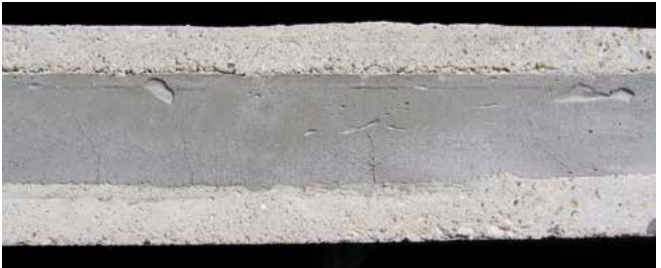
Bild 7: Schichtaufbau einer Platte für einen Vierpunktbiegeversuch, hier bestehend aus Normalbeton in den 2 bzw. 3 cm dicken Deckschichten und einer 5 cm dicken Schicht aus Porenleichtbeton in der Mitte
