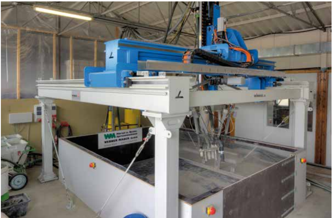
Bild 1: Prototyp der Herstellungsplattform für gradierte Betonbauteile
