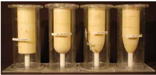
Bild 4: Vorbereitung für die Herstellung der Versuchskörper; zu sehen sind hier die zusammengesetzten Schalungen für die Realisierung der Krafteinleitungsbereiche [5] [Foto: ITE]
