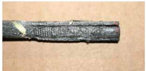
Bild 11: Versagensbild nach einem Keilzugversuch [Foto: Michael Henke]
