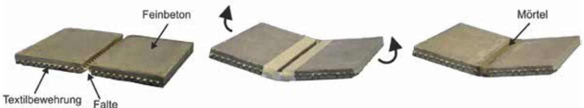
Bild 1: Grundprinzip des Faltens von Beton [7]
