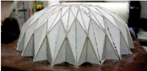
Bild 10: Oridome, gefügt aus 20 Segmenten im Modellmaßstab [16]
