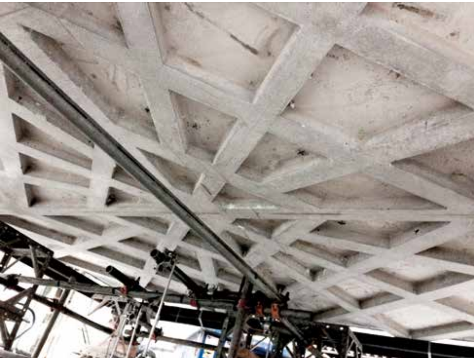
Bild 8: Rippendecke mit Messgestell im Prüffeld des IfM
