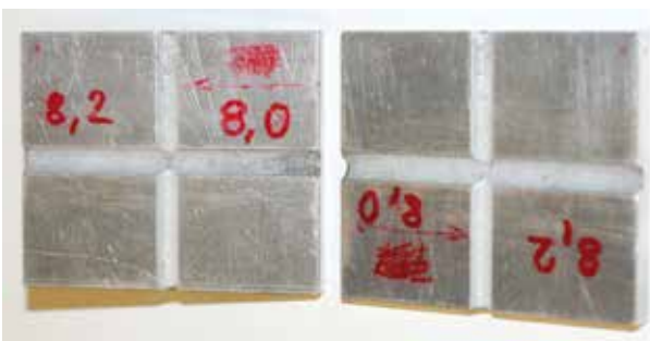
Bild 8: Klemmverankerung aus Aluminiumplatten [Foto: Michael Henke]
